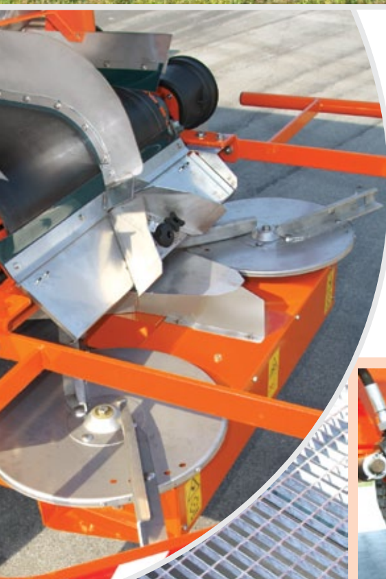
Sito w zbiorniku załadunkowym
