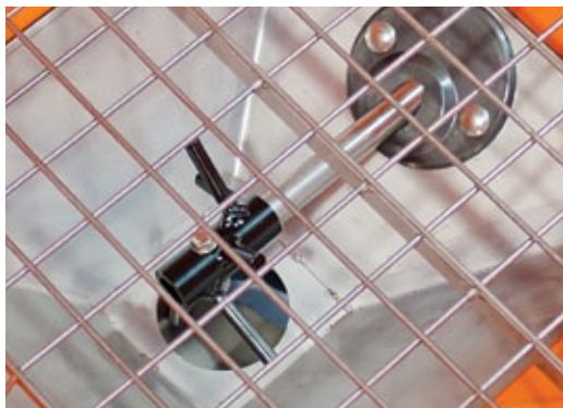
Standardowe sito filtrujące oraz mieszadło z ultra wolnym obrotem
