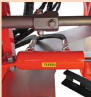
Podwójny układ hydrauliczny do otwierania i zamykania wylotów nawozowych
