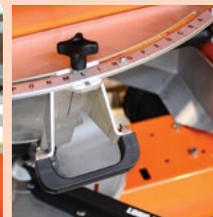
Ustawienie wskaźnika odpowiadającego tabeli wysiewu dla wysoce dokładnemu nawożeniu
