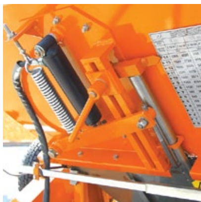
Hydrauliczna regulacja ilości nawozu
