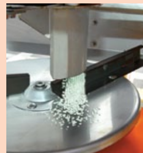
kontrolująca przepływ nawozu przez talerze wysiewające
